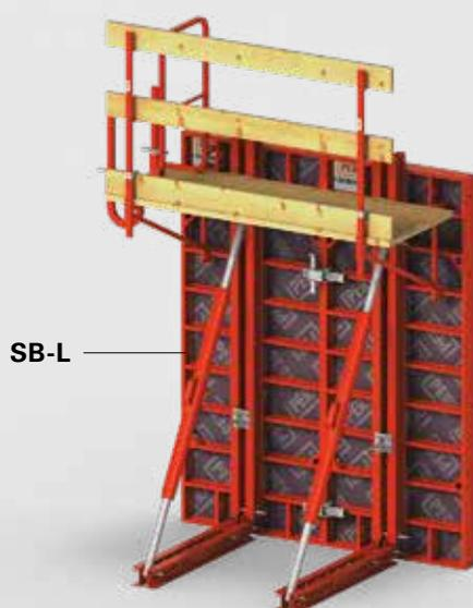
Das Stützbocksystem besteht aus 3 Varianten. Die Stützbockrahmen SB-A0, A, B und C können einzeln oder in Kombination für unterschiedliche Höhen eingesetzt werden. Sie lassen sich modular mit Bolzen und Federstecker bis zu 8,75 m aufstocken.
