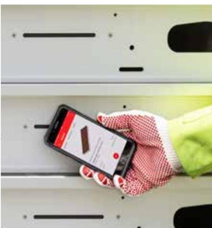
Für den Scanvorgang benötigen Sie lediglich Ihr Smartphone sowie die PERI MATERIAL SCAN App. Halten Sie Ihr Smartphone in die Nähe des RFID-Tags. Zusätzlich ist die Erfassung der Paneele mit einem UHF-Lesegerät möglich.
