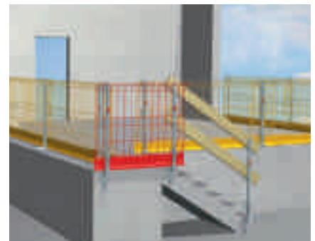
Treppengebiete lassen sich mit Geländerbrettern sichern, die leicht an den Pfosten anzubringen sind.
