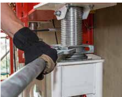
Der Mutternschlüssel HD wird zum Lösen der Druckstützenfußspindel HD, der Kopfspindel HDK 45 bzw. Spindeln, die mit der Stellmutter TR 110 ausgestattet sind, verwendet.
