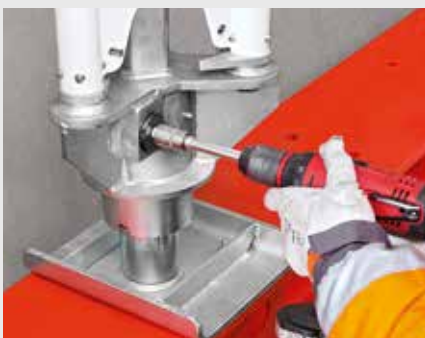
Das Absenkgetriebe mit 10 cm Absenkweg zum leichten Ausschalen unter Vollast ist allseitig 3° schwenkbar.
