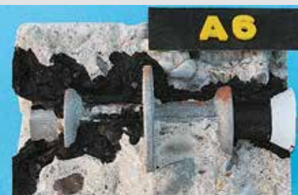
Schwindrissbildung gefährdet die Wasserundurchlässigkeit bei Wasserstoppmittelteilen ...
