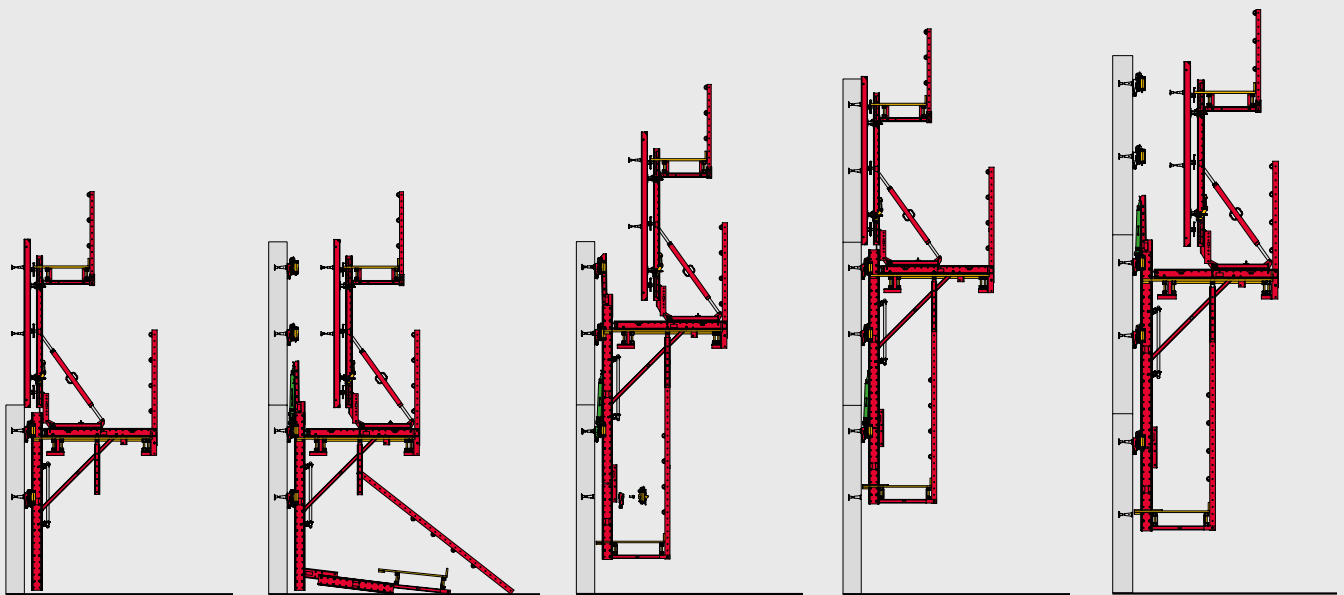
Einsatz der RCS CL am ersten Betonierabschnitt.
