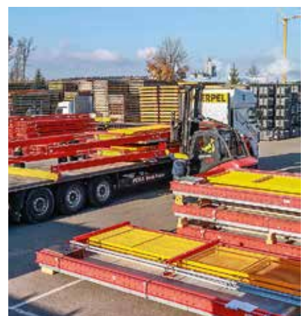
Die Bühnen sind 3,00 m breit. Sie lassen sich vormontiert stapeln und platzsparend transportieren. Die Absturzsicherung wird vor Ort einfach aufgesteckt und mit Bolzen gesichert.
