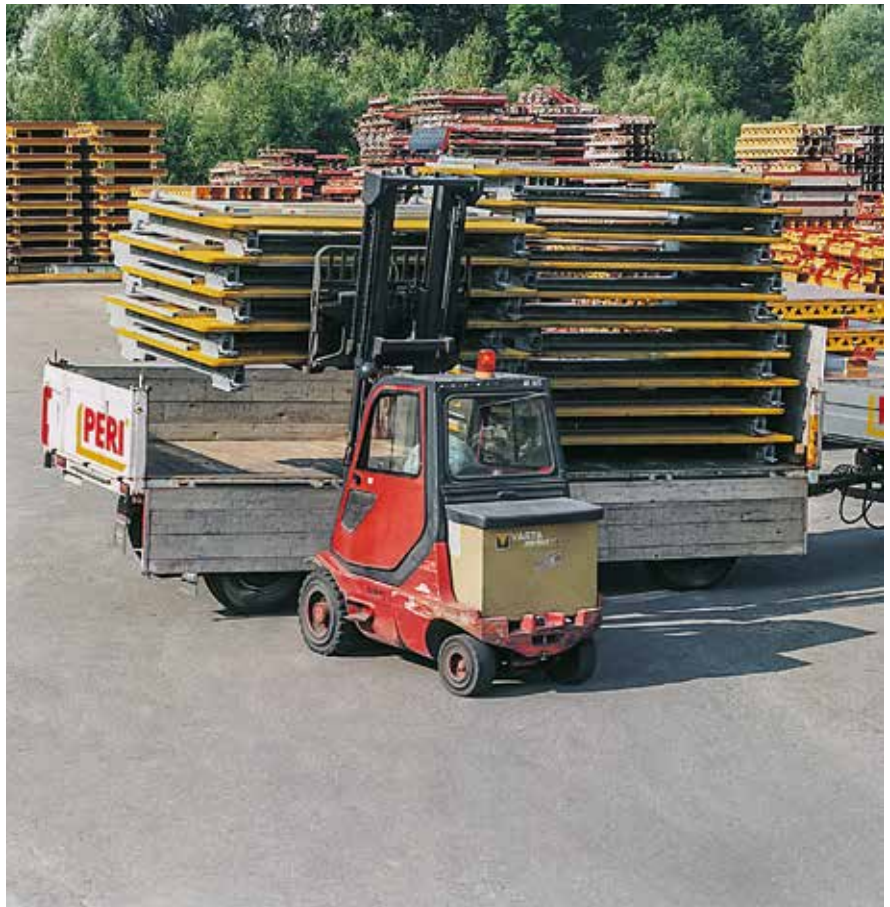
Die Zwischenbühne lässt sich mit 2,40 m Breite platzsparend quer verladen. Die Stapelhöhe einer einzelnen Zwischenbühne beträgt lediglich 9 cm, für neun Elemente ergeben sich 81 cm Stapelhöhe.
