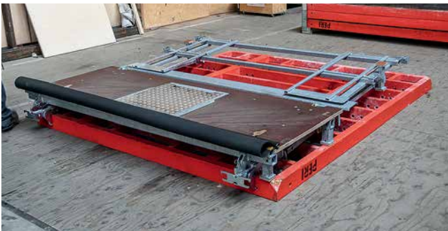
3. MXP Bühne in den Bühnenanschluss einbolzen.
