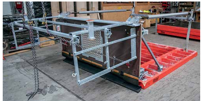
6. Richtstützen und Basisstreben montieren.
